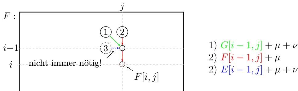
Abbildung 5.35: Skizze: Erweiterung eines Alignments mit einer Deletion
