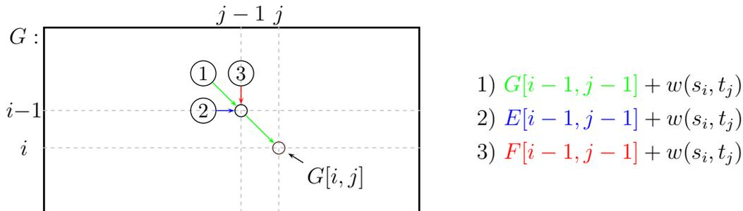
Abbildung 5.36: Skizze: Erweiterung eines Alignments mit einer Substitution
