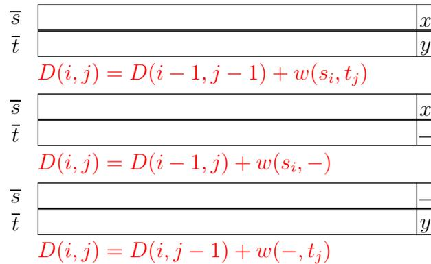
Abbildung 5.9: Skizze: Erweiterung eines optimalen Alignments zu  $s_1 \cdots s_i$  mit  $t_1 \cdots t_j$
