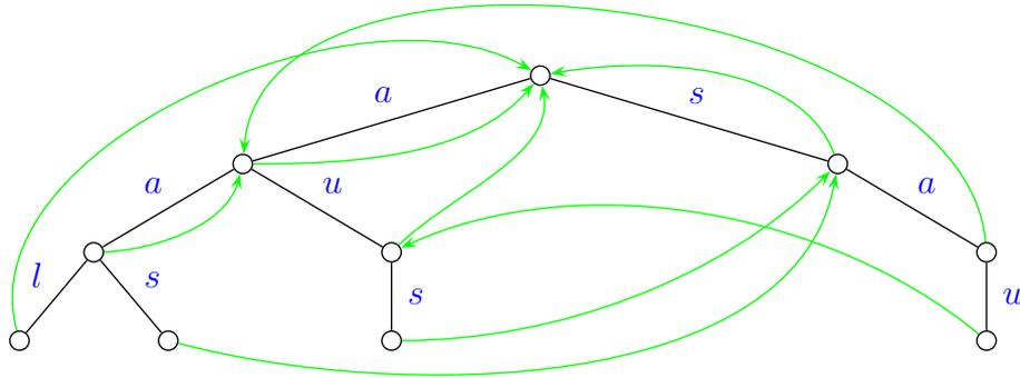
Abbildung 3.12: Beispiel: Der komplette Baum mit allen Failur-Links
