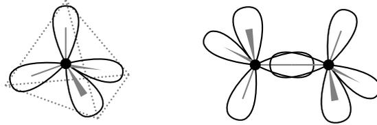
Abbildung 1.4: Skizze:  $sp^3$  hybridisierte Orbitale sowie eine Einfachbindung
