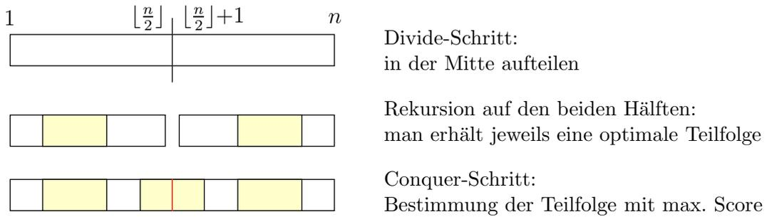
Abbildung 2.8: Skizze: Divide-and-Conquer bei Maximal Scoring Subsequences
